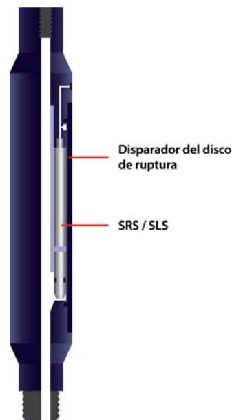
Fig. 4. Herramienta para la toma de muestra de fluido de fondo en pruebas de perforación y completación DST
