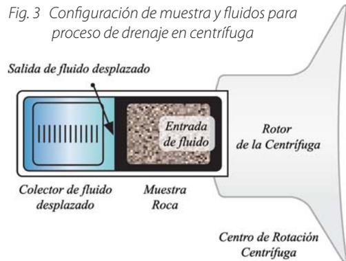
Fig. 3 Configuración de muestra y fluidos para proceso de drenaje en centrifuga
