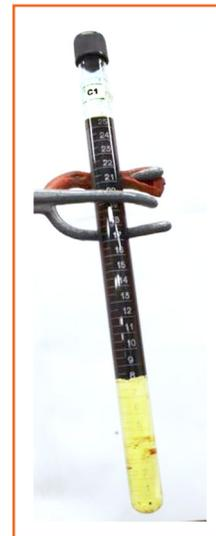
Fases separadas de la emulsión después del contacto con Ultramix®
