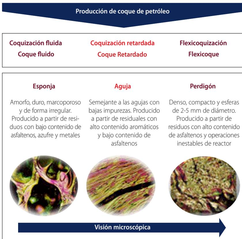
Fig. 2. Clasificación del coque de petróleo según su morfología y proceso de producción
