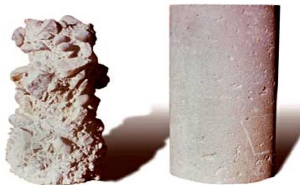
Fig. 10. Comparación del deterioro del concreto convencional (izquierda) y concreto de azufre (derecha) expuestos a inmersión de 20 % p de ácido sulfúrico [35]
