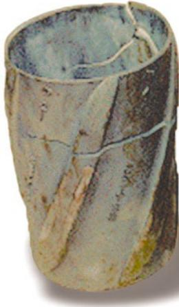
Fig. 13. Mala calidad de los centralizadores puede comprometer la integridad del pozo.
