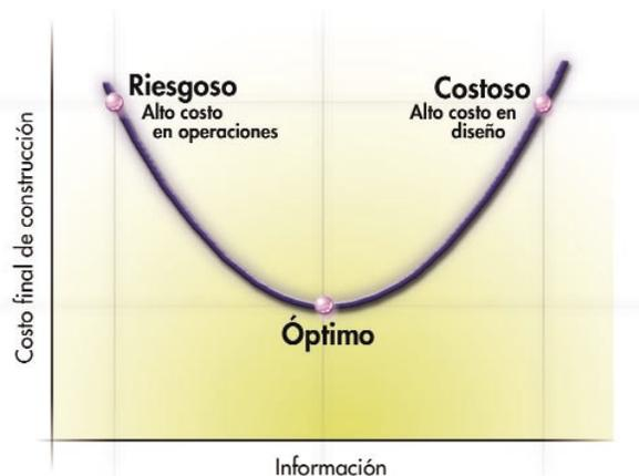
Fig. 1. Modelo teórico de optimización de costos en la construcción de pozos, considerando información/riesgo.
