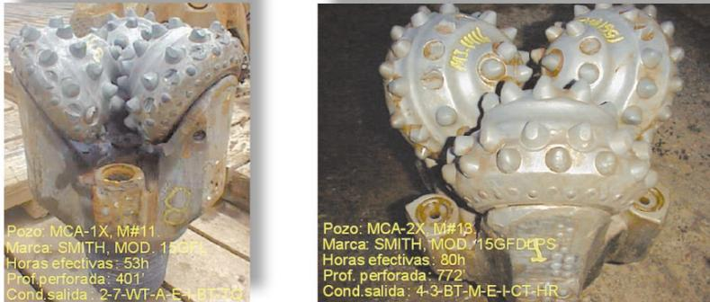
Fig. 9. Comparación del desgaste de la estructura de corte de dos mechas SMITH serie 15 GF.
