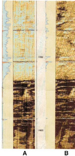
Fig. 19. A) Registro ultrasónico corrido 50 horas, luego del trabajo de cementación. B) Registro ultrasónico corrido 75 horas luego del trabajo de cementación.
