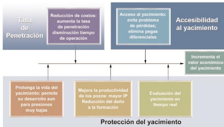
Fig. 6. Razones para perforar en condiciones de bajo balance.
