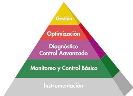
Fig. 2. Pirámide con la estructuración por niveles para aplicaciones de automatización.
