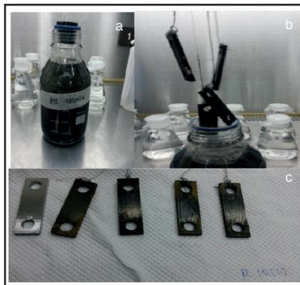
**Figura 1.** Reactor con medio de cultivo lactato de sodio (a), biocupones luego de la formación de la biopelícula (b) y comparación de biocupones con el control (c)
