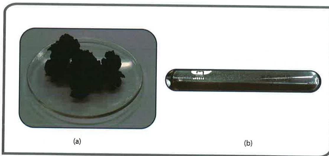
Fig. 9 (a) Muestra de depósito orgánico tomado de un pozo inyector, (b) Resultado después del contacto con ULTRAMIX®
