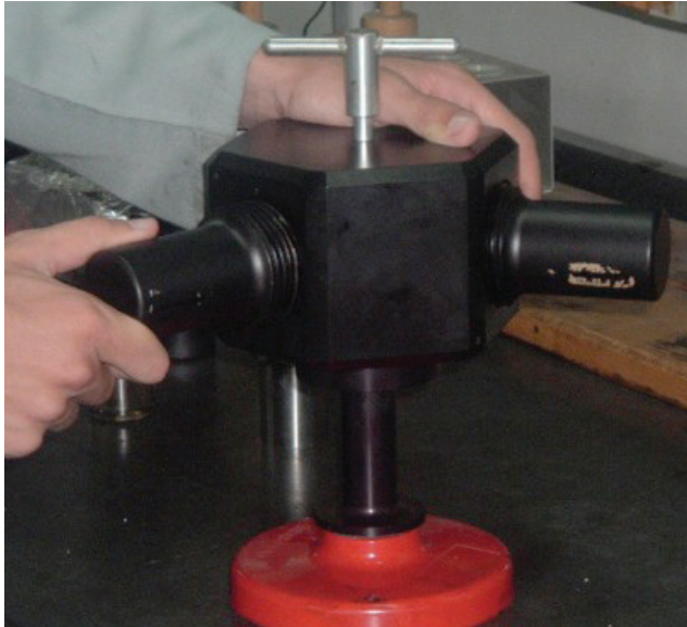
Fig. 2. Celdas de imbibición acopladas a rotor de Ultracentrífuga Beckman
