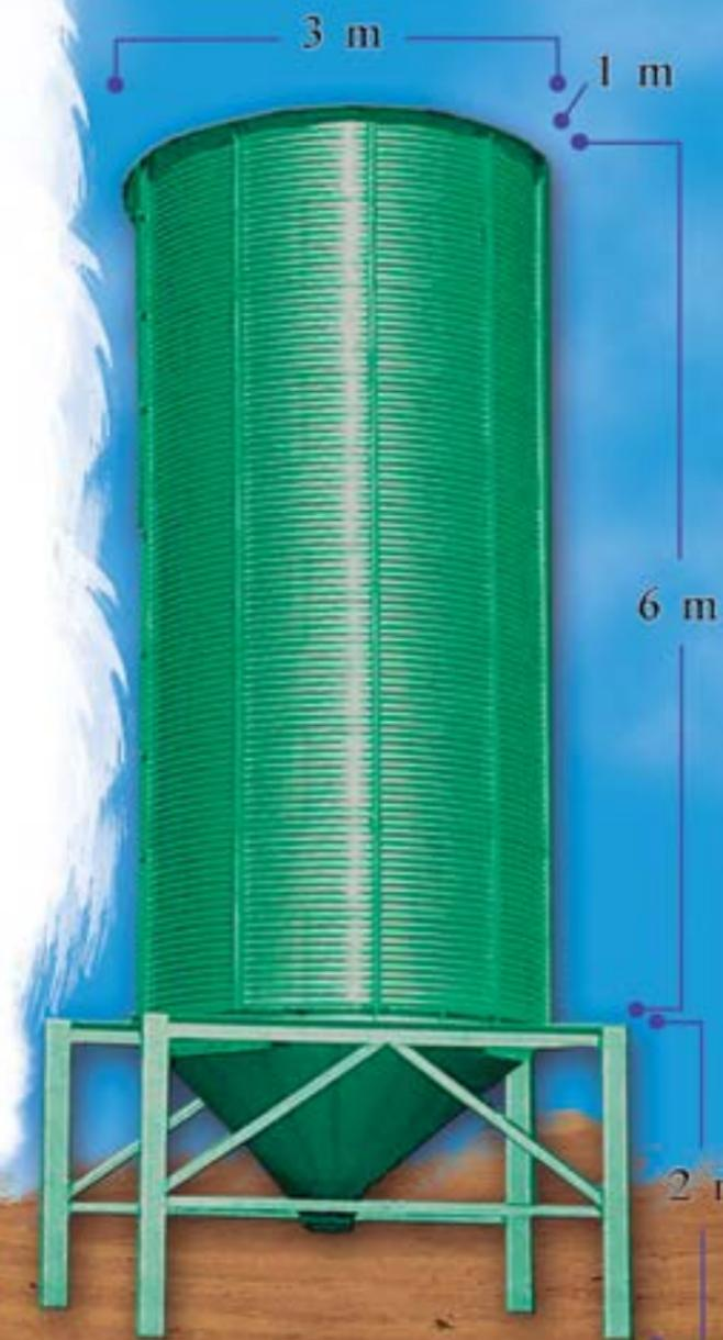
Pero además del volumen del cilindro, necesitamos el volumen de un cono (que sirve de desembocadura para la descarga del maíz; tal volumen está dado, como vimos anteriormente, por la ecuación  $V = \frac{1}{3} \pi r^2 h$ , donde  $h$  es la altura del cono y  $r$  es el radio, de la base del cono así:
