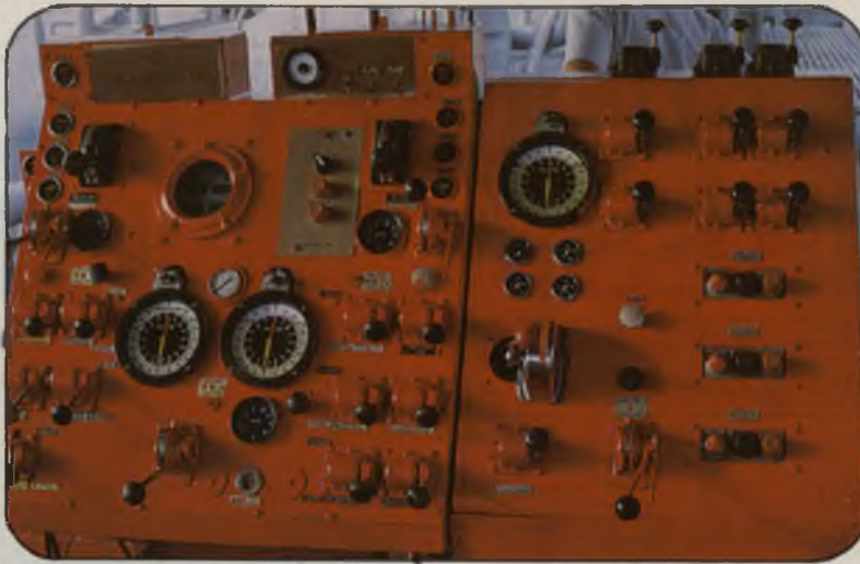
Este es parte del moderno y práctico panel de control con que cuenta la gabarra de cementación HALLIBURTON-817. Desde él son controladas y registradas todas las operaciones del sistema, una innovación en esta área.
