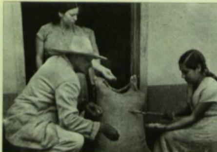
El "punzador" es un instrumento de madera, hueco y afilado en la punta; sirve para perforar los sacos de granos. De esta manera el comprador puede comprobar la buena calidad del producto sin necesidad de tener que abrir el saco.
