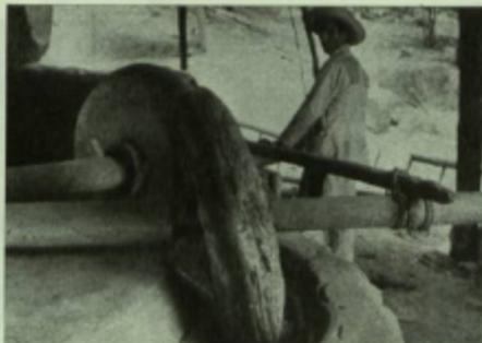
La piedra del molino es dura y pesada; las hay de diferentes tipos. La de la gráfica es bastante tosca, pero desempeña su trabajo con eficiencia. Observe el grueso de la viga que la atraviesa y la atadura de esta con el yugo
