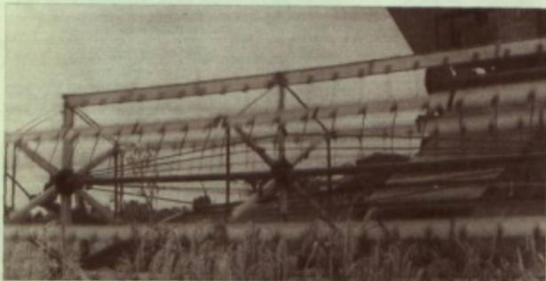
Las grandes aspas de la trilladora-segadora giran y doblan hacia adentro las espigas para ponerlas al alcance de las cizallas, que se encuentran en la parte inferior, debajo de las aspas. Allí es donde se efectúa, precisamente, el corte de las espigas maduras de arroz. Estas modernas máquinas abrevian mucho el trabajo.
