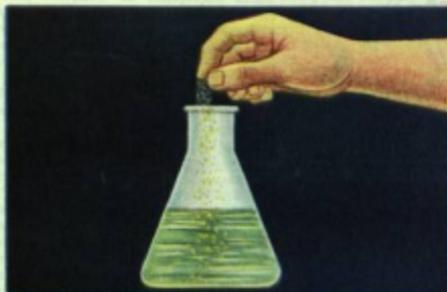
Si calentamos un líquido sobre una hornilla, reverbero u otro utensilio cualquiera, se establecen corrientes de convección que aceleran la propagación del calor. Podemos comprobarlo de la manera siguiente: Tomemos un matraz, llenémoslo de agua hasta la mitad y arrojemos dentro del
