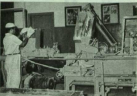
En la máquina laminadora, tal como su nombre lo indica, la goma es transformada en planchas de un determinado grosor, muy blanda todavía, aunque suficientemente compacta, para que el trabajo del operario resulte perfecto.
