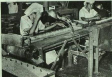
El aparato brillador, que también es un globo metálico, deja las pastillas en condiciones de resistir la última prueba de la fabricación: el examen a que las someten las revisadoras. Cualquier defecto impone inmediato rechazo.
