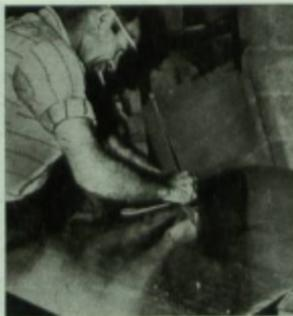
Sobre planchas de hierro galvanizado se trazan, mediante un patrón de cartón, las plantillas que lleva la horma para doblar los clavos de los zapatos.
