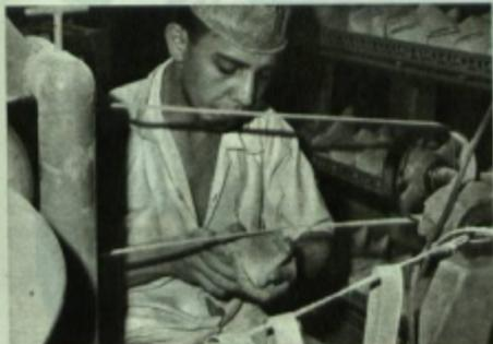
Pero la horma requiere un alisado final antes de la pulitura con cera, que es parte imprescindible de la manufactura. Para obtenerlo, los operarios se valen de cintas o correas de fibra movidas eléctricamente por una máquina.
