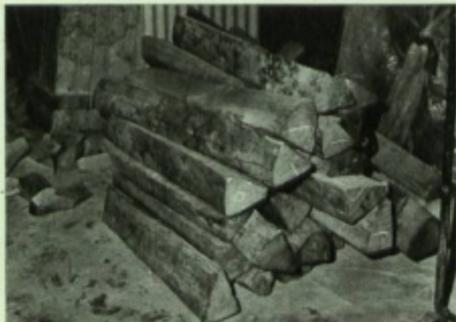
La fabricación de hormas para zapatos exige una madera especial que es traída de San Juan de los Morros (Edo. Guárico) cortada triangularmente. Al fondo, los trozos con la forma de la horma desbastada ya para iniciar el trabajo.
