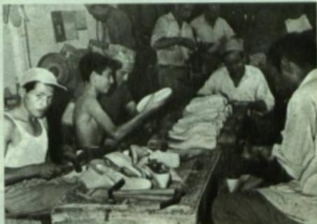
Trabajadores especializados se encargan de fijar con clavos las plantillas metálicas a las hormas, tal y como aquí se observa. Martillo en mano, estos operarios industriales complementan eficientemente el proceso de fabricación.
