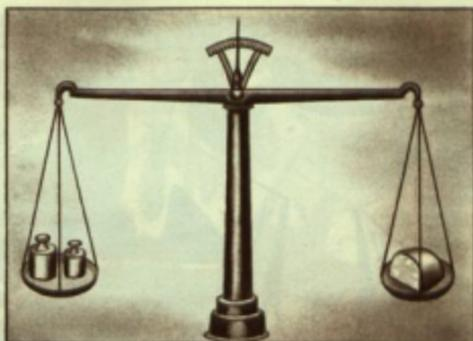
Para pesar un cuerpo se coloca éste en uno de los platillos y en el otro tantas pesas cuantas sean necesarias para que el astil quede en posición horizontal. Basta entonces sumar los números marcados por las pesas para determinar el peso exacto del cuerpo.
