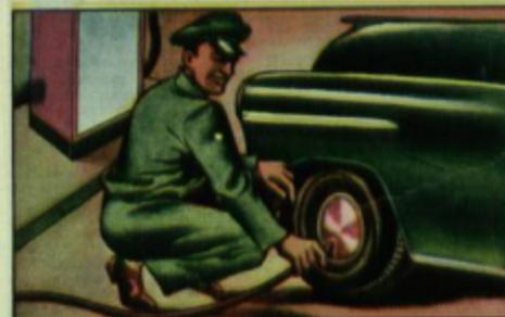
La unidad que se usa para medir la presión de los gases se denomina "atmósfera" y equivale a la presión ejercida por Kg. 1,033 sobre una superficie de 1 cm.<sup>2</sup> Cuando decimos que el aire está comprimido a 10 "atmósferas" se entiende que ejerce en las paredes del recipiente que lo contiene una presión de Kg. 1,033 x 10 = 10,33 por cm.<sup>2</sup>
