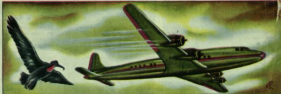
La aviación es un sistema de locomoción aérea que tiene el mismo fundamento que el vuelo de las aves. Los aviones no utilizan el principio de Arquímedes para volar, ya que pesan mucho más que el aire que desalojan. Impulsados por motores potentísimos, se mueven rápidamente y se sostienen y se elevan por la resistencia oblicua que
