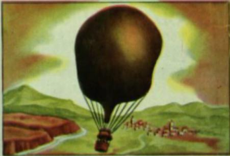
en la parte superior del aparato, y por el orificio se escapa una porción del gas interior; de este modo disminuye el volumen del globo y aumenta su peso específico. Al hacerse más pesado que el aire, comenzará a descender. Los globos son muy útiles en la meteorología para estudiar las regiones elevadas de la atmósfera.
