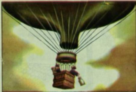
aire suficientemente enrarecido, en la que el peso total del aparato es igual al peso del aire desalojado. Si en tal estado de equilibrio el aeronauta quiere elevarse más, suelta cierta cantidad de arena o lastre, y entonces el globo, descargado de peso, continuará ascendiendo. Para bajar abre, por medio de una cuerda, una válvula colocada
