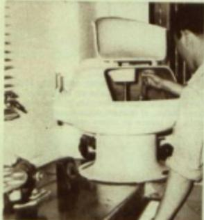
En un laboratorio bien equipado este experto comprueba la densidad de la leche, para lo cual utiliza el instrumento de medición llamado areómetro, que es de muy fácil manejo.
