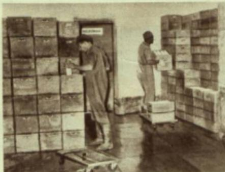
En el interior de estos grandes depósitos refrigeradores se almacenan las gaveras con los envases. La temperatura apropiada que continuamente se mantiene en las cavas, conserva la leche en las condiciones requeridas durante el corto tiempo que allí permanece.
