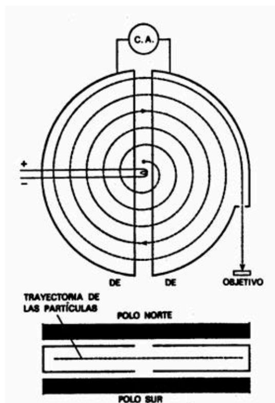
Fig. 7.5. Principio del ciclotrón visto desde arriba (parte superior) y en su sección transversal (parte inferior). Las partículas inyectadas por la fuente reciben el impulso de cada «d» mediante la carga alterna, mientras la magneto las hace curvarse en su trayectoria espiral.
