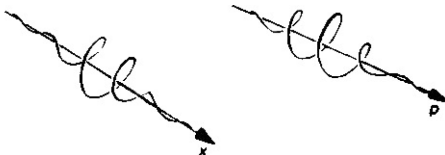
FIGURA VI.14. Paquetes de ondas. Están localizados tanto en el espacio de posiciones como en el de momentos.
