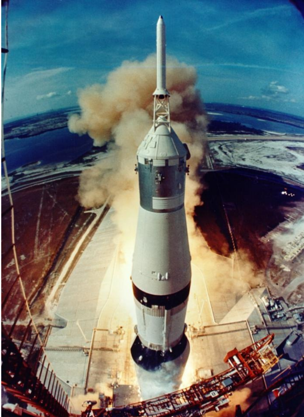
Un cohete posterior de varias fases y combustible líquido, descendiente directo de los primeros intentos de Goddard. El Apolo II, pilotado por Neil Armstrong, despegó el 16 de julio de 1969 de Cabo Cañaveral, Florida, para un vuelo de tres días a la Luna. (Cedida por la NASA.)
