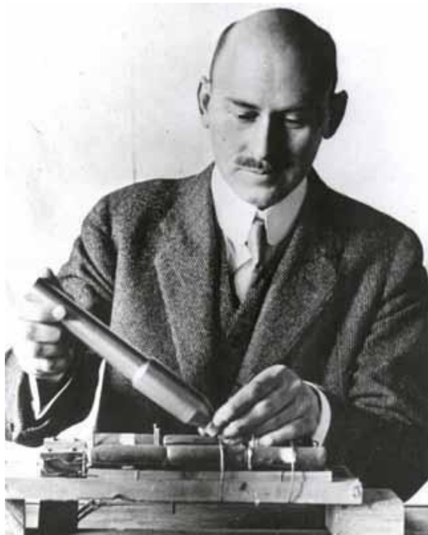
(Izquierda) Goddard a los treinta y cinco años, ajustando a un banco de pruebas una cámara de combustión en acero de un pequeño cohete de carburante sólido. (Derecha) El primer cohete de combustible líquido que llegó a volar. Lanzado por Robert Goddard el 16 de marzo de 1926, desde la granja de su tía Effie en Auburn, Massachussets, su vuelo duró dos segundos y medio. (Imágenes cedidas por la Biblioteca Goddard, Universidad Clark.)
