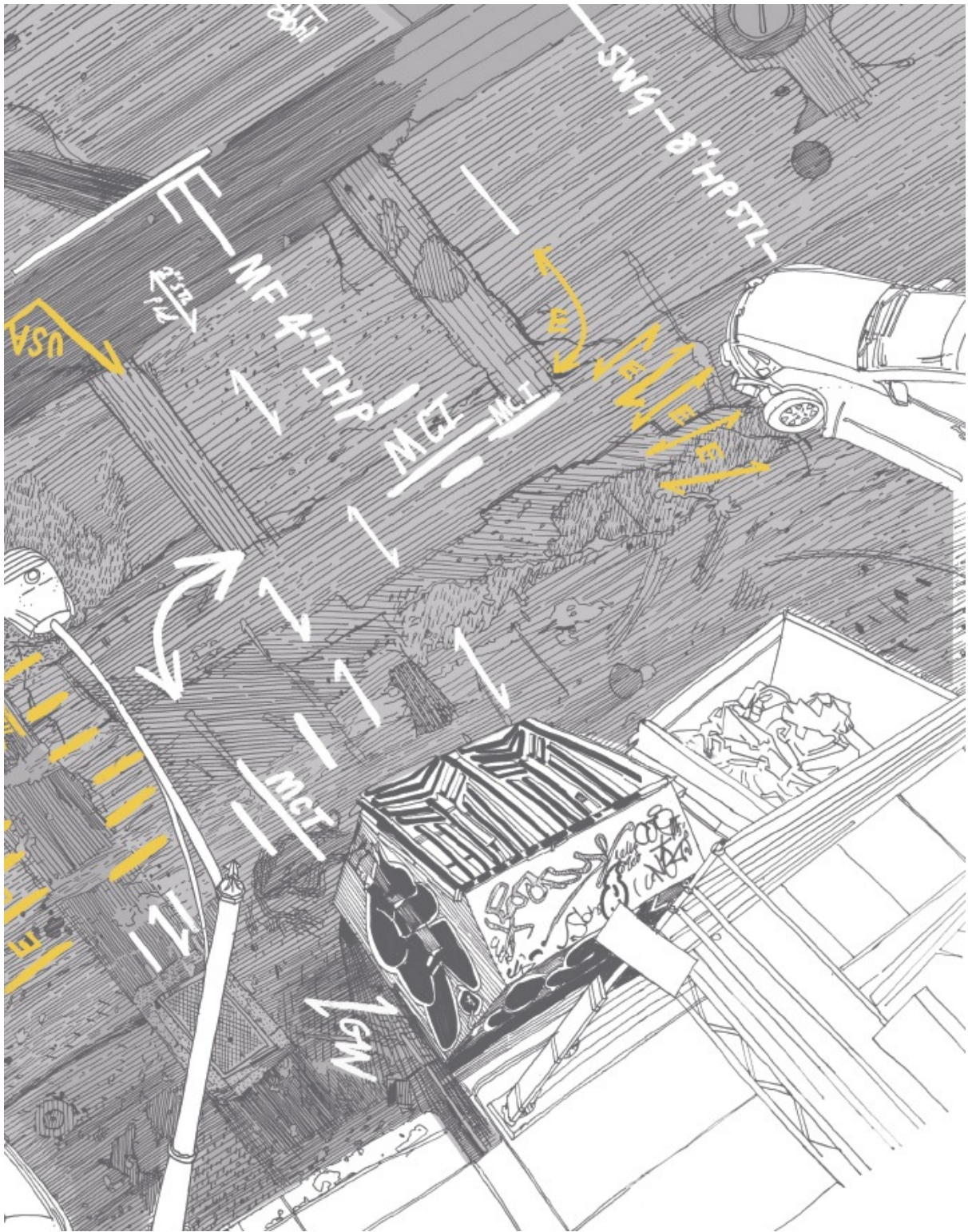
Códigos de utilidad escritos con espray que indican peligros bajo tierra en Oakland.
