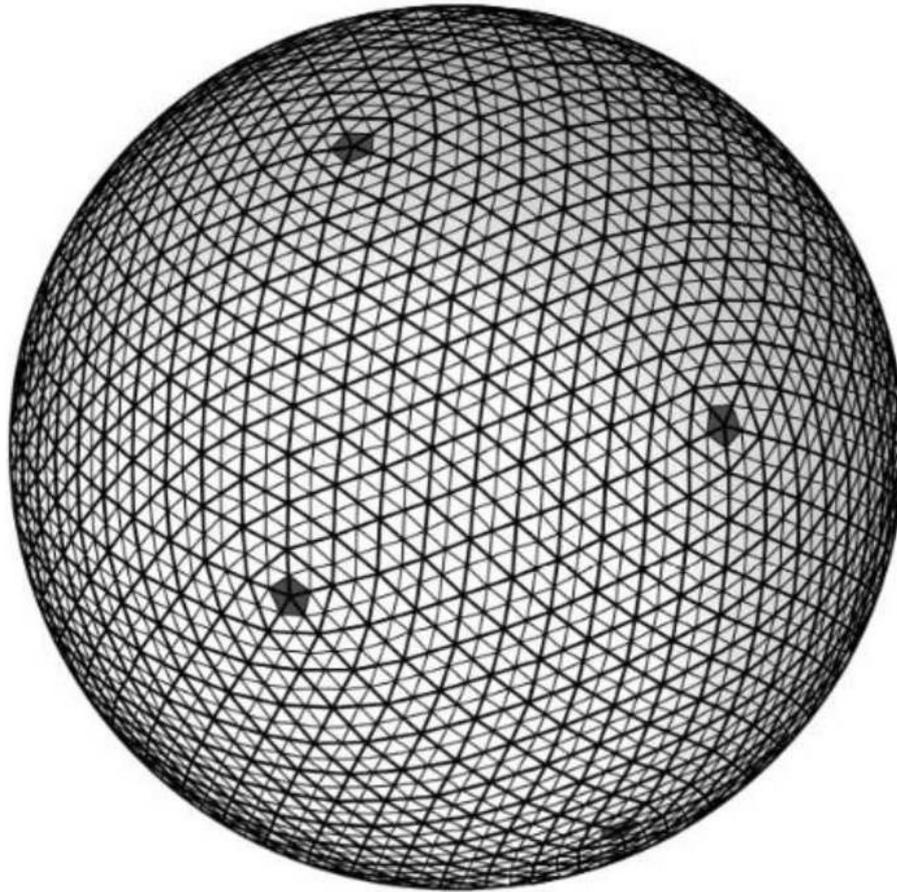
*Representación de la Geoda y de sus miles de triángulos. Los puntos en los que se agrupan cinco triángulos están señalados en gris oscuro.*
