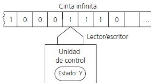
*Esquema sencillísimo del funcionamiento de una máquina de Turing.*
