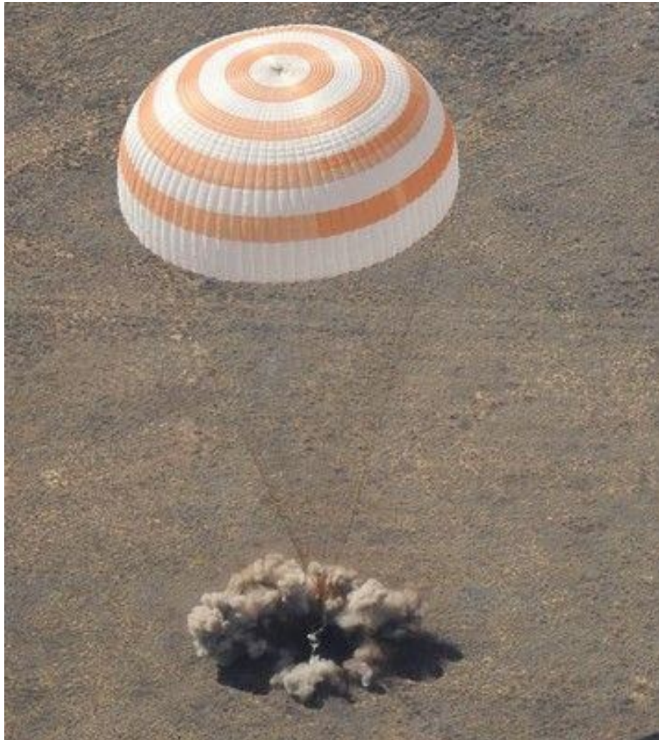
Imagen: La nave Soyuz utiliza para su aterrizaje una combinación de sistemas, el paracaídas, que actúa como elemento principal, y un sistema de retrocohetes que realiza un frenado final para un aterrizaje suave. En la fotografía se observa la nube de polvo levantada por la activación de este sistema de retrocohetes instantes antes de tomar tierra. (Foto: NASA)
