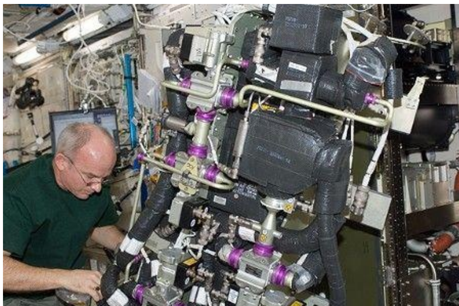
Imagen: Un astronauta trabaja en el mantenimiento de los filtros de CO 2 de fabricación norteamericana CDRA en el interior del módulo japonés Kibo de la Estación Espacial Internacional. (Foto: NASA)
