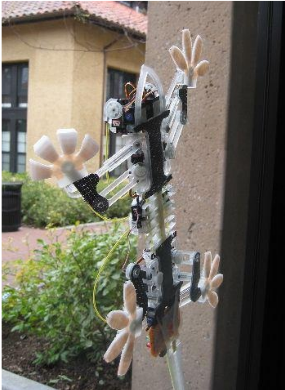
Imagen: Un robot capaz de trepar por superficies totalmente lisas como un vidrio de ventana, basado en la imitación del gecko. (Foto: MIT)
