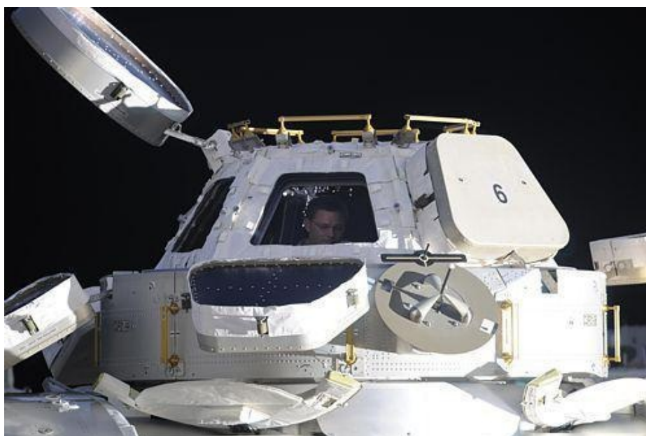
Imagen: Cupola vista desde el exterior de la ISS; puede observarse cómo alguna de las ventanas se encuentra cerrada por la portezuela de protección (derecha). (Foto: ESA)
