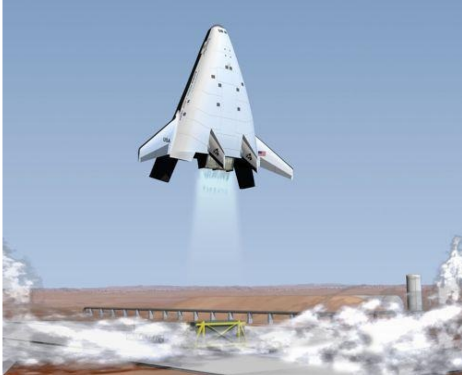
Imagen: El X-33 de la NASA investigaba el concepto SSTO en busca de un considerable abaratamiento del acceso al espacio. (Imagen: NASA)
