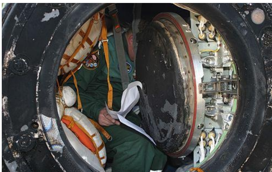
Imagen: Los alrededores de la escotilla, que teóricamente se encuentra en el lugar más alejado de la zona de mayor calentamiento durante la reentrada, presentaban graves signos de recalentamiento en el caso de la Soyuz TMA-11. (Foto: Novosti-Kosmonavtiki)
