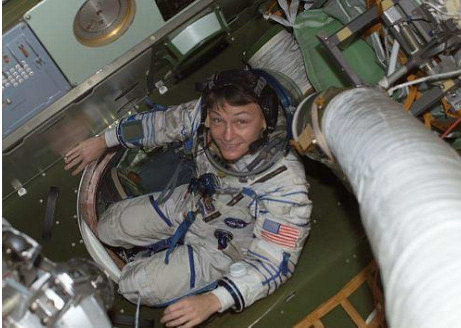
Imagen: La astronauta Peggy Whitson pasando a través de la escotilla de una nave Soyuz acoplada a la Estación Espacial Internacional. Obsérvense las reducidas dimensiones de la escotilla, de 80 centímetros de diámetro.
