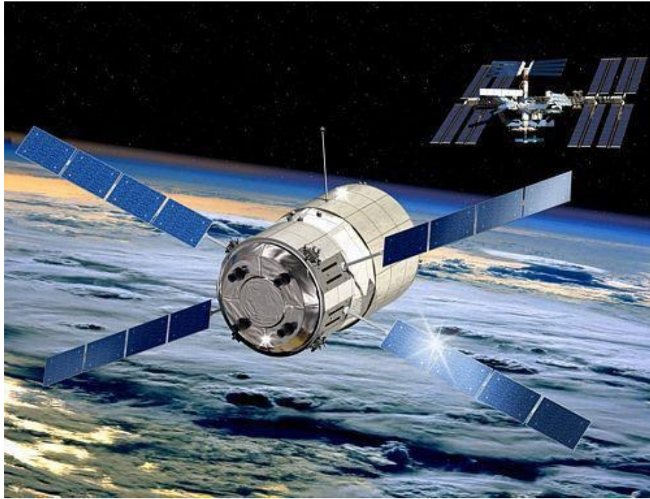
Imagen: La nave de carga ATV es el equivalente europeo de las Progress rusas, pero con una mayor capacidad de carga. El primer ATV se acopló a la ISS el 4 de abril de 2008. (Imagen: ESA)
