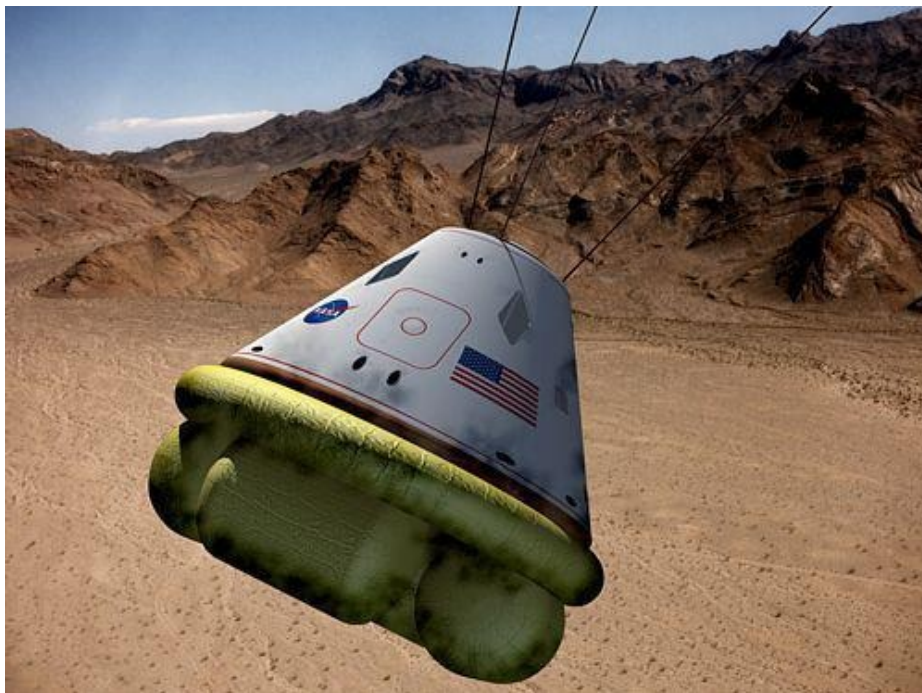
Imagen: En 2008, la premisa inicial de que la cápsula Orión fuese capaz de aterrizar sobre tierra firme, debía abandonarse debido a sus serios problemas de sobrepeso. (Imagen: NASA)
