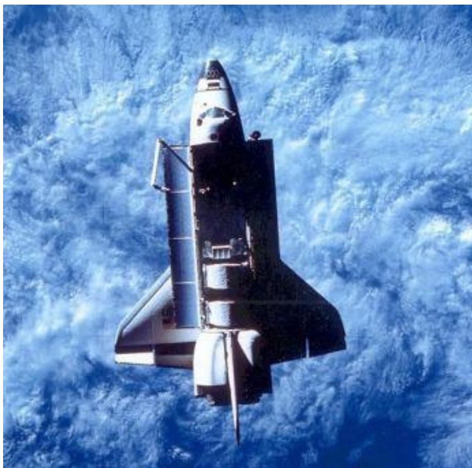
Imagen: El transbordador espacial norteamericano lleva sus radiadores instalados en la parte interior de las compuertas de la bodega. Por esta razón, las compuertas siempre permanecen abiertas cuando se alcanza la órbita terrestre, para irradiar el exceso de calor al exterior. (Foto: NASA)
