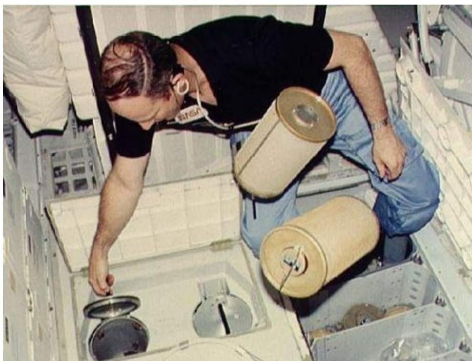
Imagen: Un astronauta cambia los filtros de hidróxido de litio a bordo del transbordador espacial. Los filtros son sistemas no reutilizables, que se saturan y es necesario renovar cada cierto tiempo. (Foto: NASA)
