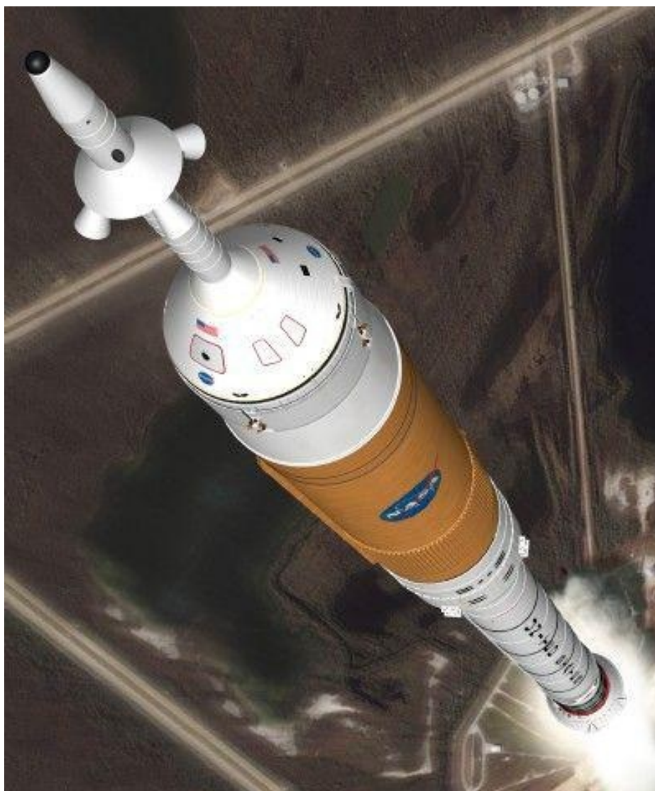
Imagen: El cohete Ares I, encargado de llevar a la órbita terrestre la nave tripulada Orión, sería el primer lanzador tripulado de la historia en utilizar propulsante sólido. (Imagen: NASA)
