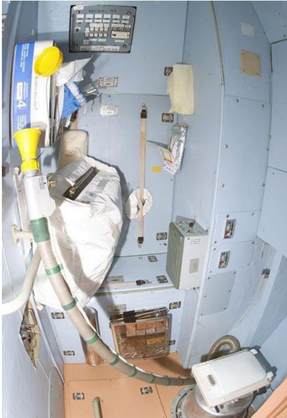
Imagen: El inodoro ruso de la ISS, durante muchos años el único que ha existido a bordo de la estación. El tubo con el embudo amarillo es el dispositivo para la recogida de orina. (Foto: NASA)
