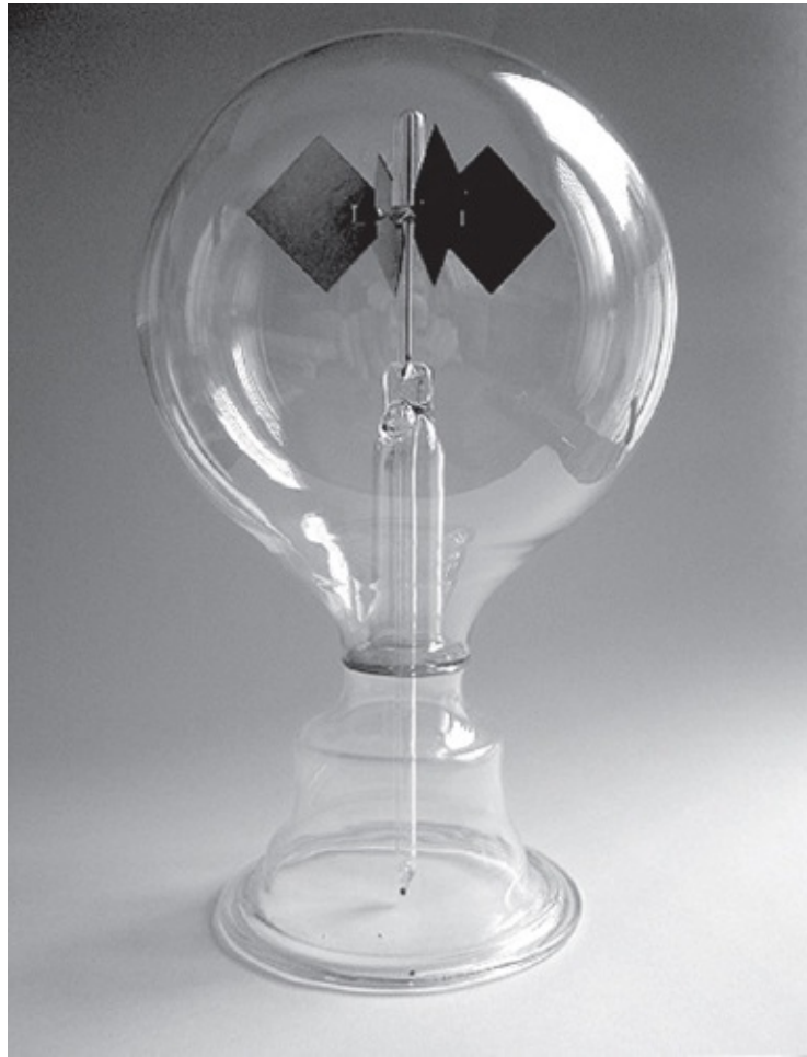
Un radiómetro de Crookes —la veleta de cuatro alas rota cuando la luz la ilumina.
