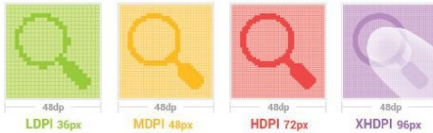
Figura 11.3. Es necesario diseñar una imagen para cada densidad en la que funcionará la aplicación. En este caso, un ícono de buscar se diseña para todas las densidades de Android.
