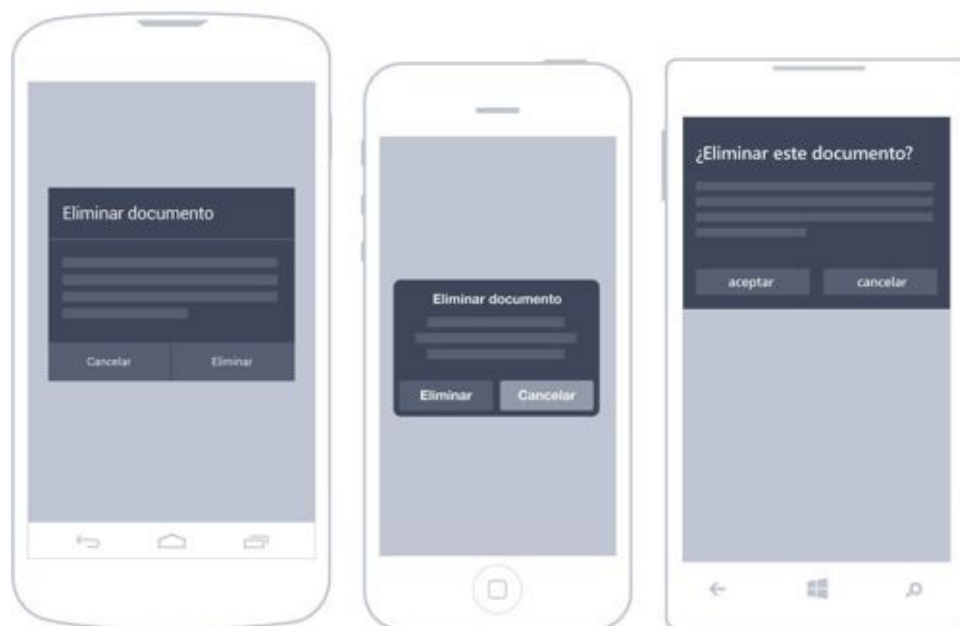
Figura 7.16. Cuadros de diálogo que requieren la toma de decisiones por parte del usuario en Android, iOS y Windows Phone.
