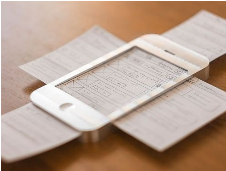
Figura 5.5. Los wireframes son fundamentales para entender cómo puede estar estructurada cada pantalla de una app.
