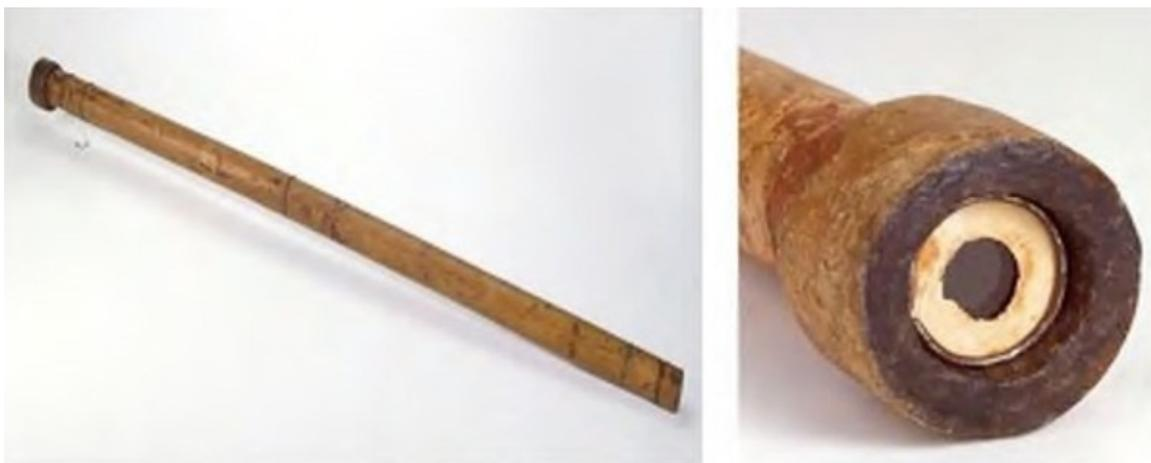
Fig. 39. Galileo Galilei, Telescopio, ca. 1610, 127, 3 cm (largo), madera, papel, cobre. Florencia, Museo Galileo (inv. n.º 2427).
