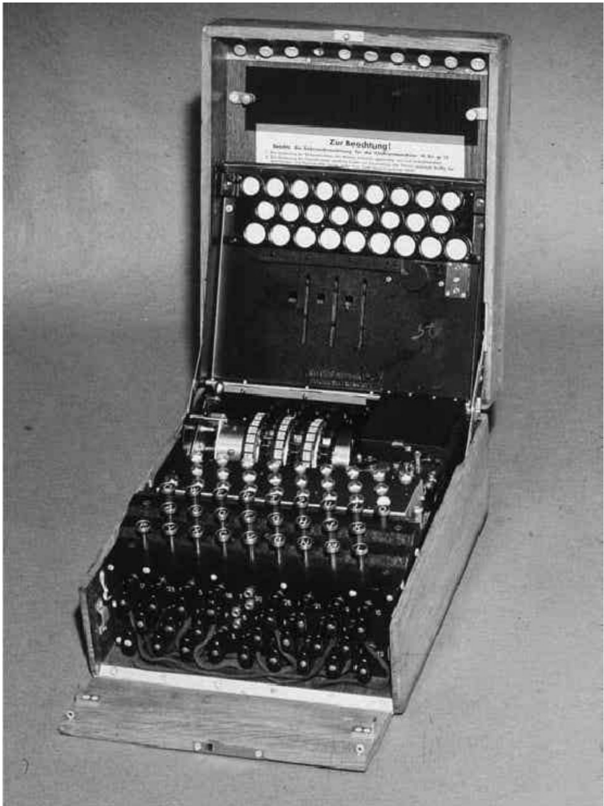
La máquina Enigma, usada por los alemanes para cifrar mensajes secretos durante la Segunda Guerra Mundial. (Hulton Archive/Getty Images).
