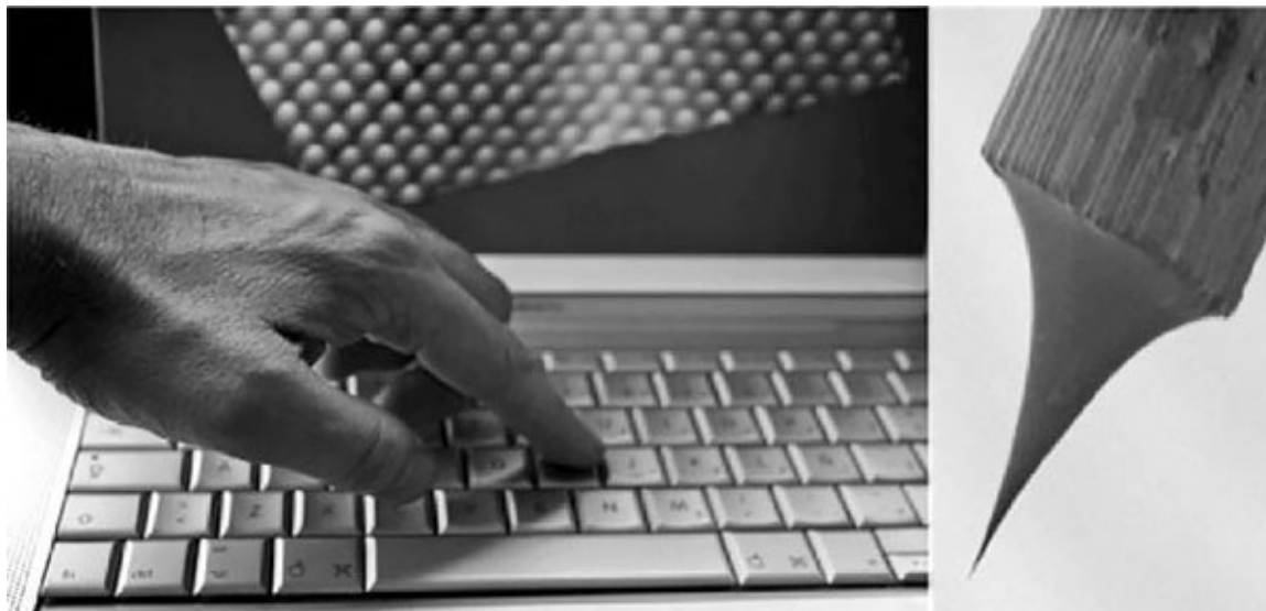
FIGURA 2.6. A la izquierda, analogía del funcionamiento de un microscopio de campo cercano o SPM: una afiladísima punta se pasea sobre una superficie sin prácticamente tocarla, como podemos hacer con el dedo sobre el teclado de un ordenador. A la derecha, fotografía obtenida con un microscopio electrónico de barrido de una punta de tungsteno utilizada para realizar imágenes con un STM.
