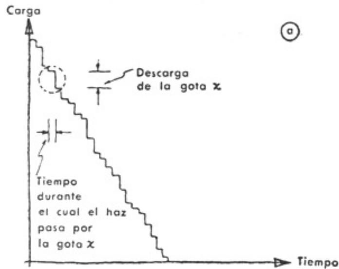
Figura 21A. Existen dos métodos para hacer variar la carga eléctrica inducida en la placa de señales del iconoscopio: mediante la descarga sucesiva de las gotitas, a medida que son exploradas por el haz electrónico, y por la carga continua de todas las gotitas debido a la luz que incide sobre ellas desde la escena. En A se ve el efecto de la descarga.
