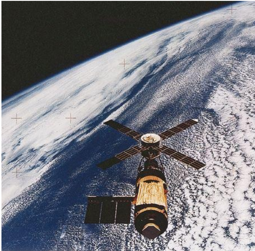
El Skylab, con un panel solar de menos y una capota de lona
