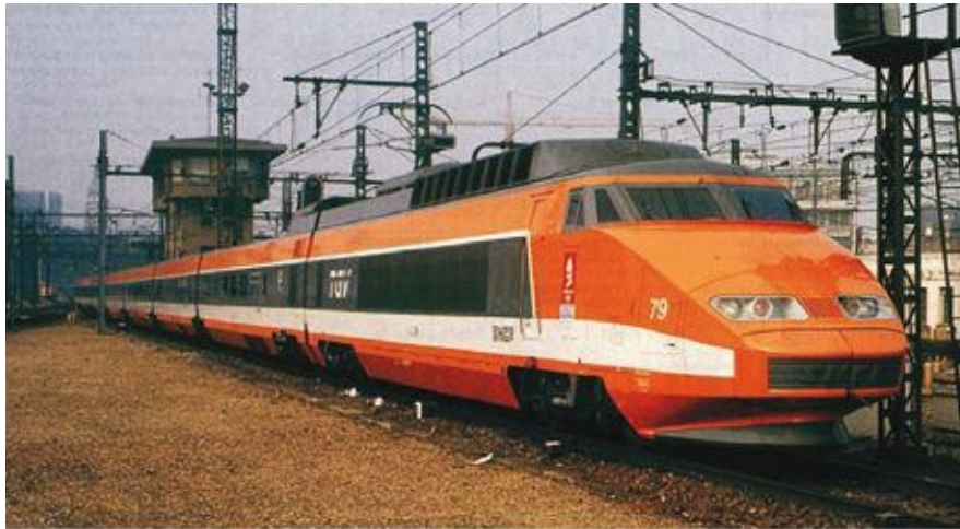
El TGV francés con su catenaria y pantógrafo.
