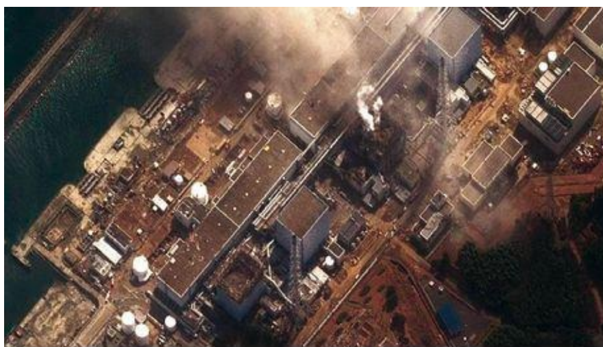
Aquí se ve la central de Fukushima Daiichi justo después de que estallara el hidrógeno acumulado en el edificio del reactor n.º 3 (el que humea) y antes de los incendios del n.º 2 y el n.º 4 (fuera de esta foto). Se puede apreciar la proximidad del océano que, a la postre, resultó fatal.
