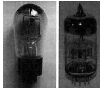
Dos clases de válvulas: diodo (izquierda) y triodo (derecha).
