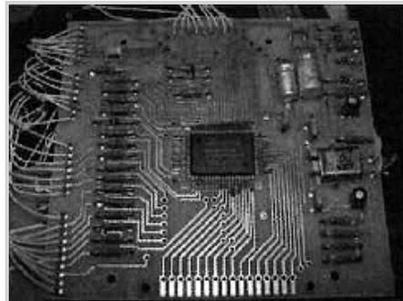
Franz Morsch, circuito integrado diseñado específicamente para jugar al ajedrez.
