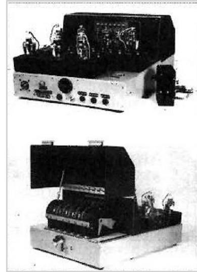
Máquinas para el sistema de encriptado de voz *Delilah*.
