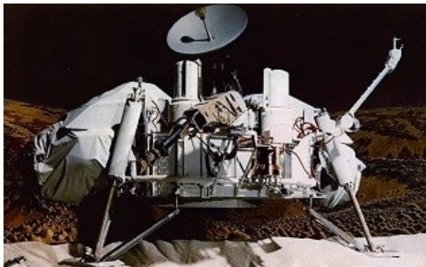
LÁMINA 4. Nave espacial Viking . Se puede observar el brazo robotizado que se utilizó para recoger muestras para análisis biológicos.
