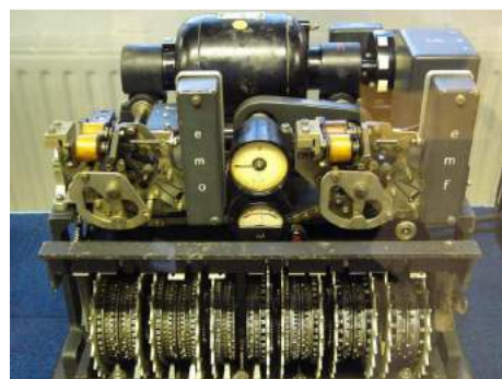
Máquina alemana de cifrado de Lorenz, usada en la segunda Guerra Mundial para el cifrado de los mensajes para los generales de muy alto rango
