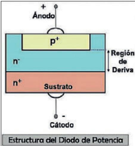
Estructura básica de dispositivo semiconductor
