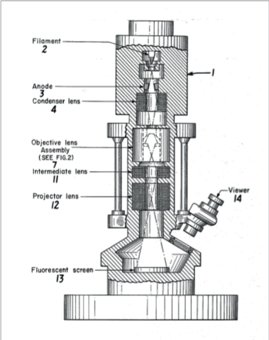
En la imagen, tomada de uno de los documentos de solicitud de patente del Dr. Fernández-Morán, se muestra el diagrama de un Microscopio Electrónico de Transmisión. Obsérvese el visor señalado con el número 14
