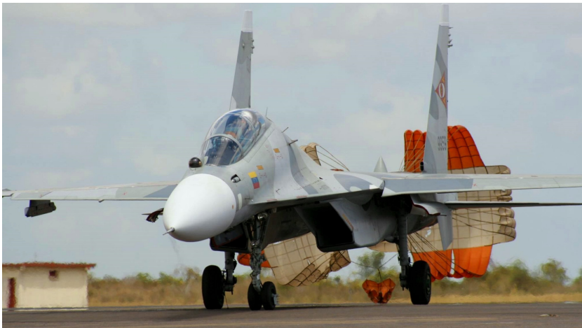
Foto N° 26. Un paracaídas de frenado está diseñado para desplegarse desde una aeronave en rápido movimiento para reducir la velocidad, proporcionar control y estabilidad al aterrizar. En comparación con un paracaídas convencional, este es más alargado y tiene una superficie mucho menor; puede desplegarse a velocidades a las que los paracaídas convencionales se desgarrarían. En la imagen, un avión Sukhoi 30Mk2 muestra su paracaídas de frenado desplegado luego del aterrizaje. Fuente: Aviación Militar Bolivariana, 21 de julio de 2020.
