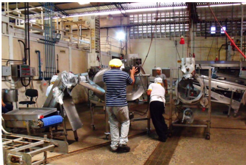
Foto N° 6. Los trabajadores de Alina Foods C.A. , organizados como una fuerza de rescate ingenieril, movilizan uno de los tambores giratorios para condimentar, después que fuere reconstruido por los talentos de Cenditel. Fuente: Cenditel, octubre de 2022.
