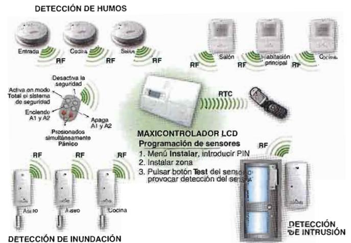
Fig. 6.11. Alarmas RF con el maxicontrolador LCD.
