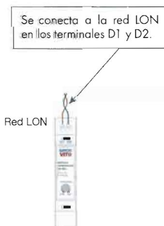
Fig. 9.10. Conexión del módulo de terminación de red.
