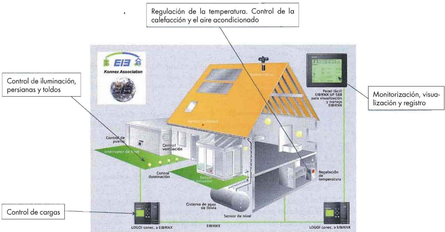
Fig. 8.1. Aplicaciones básicas del sistema KNX en viviendas. (Fuente: Siemens.)
