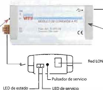
Desde la regleta del módulo de conexión al PC se conectan los cables a través de una manguera de un par UTP categoría 5 a cualquier punto de la red del sistema. La conexión a la red no tiene polaridad.
