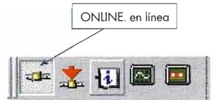
Fig. 8.10. Conexión con el bus en la barra de estado.
