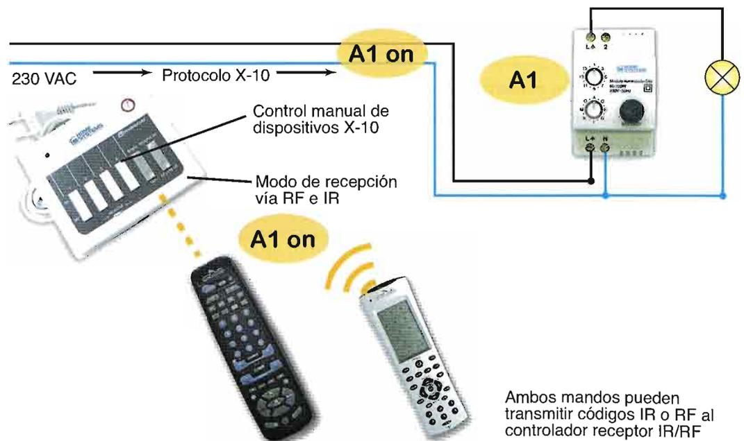
Ambos mandos pueden transmitir códigos IR o RF al controlador receptor IR/RF
