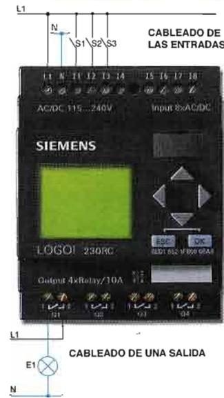
Fig. 3.9. Cableado de un modelo de LOGO! de 230 VCA.
