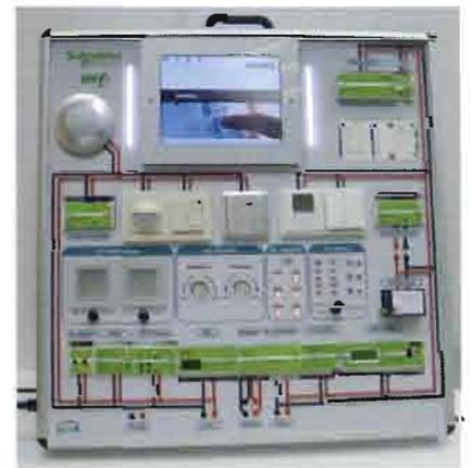
Fig. 8.30. Entrenadores de domótica de Siemens y Schneider Electric.
