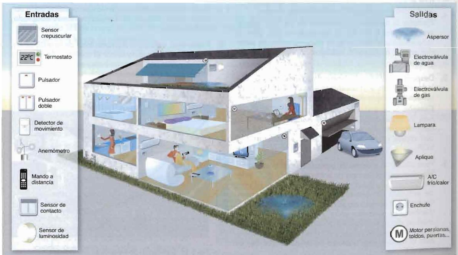
Fig. 9.26. Entradas y salidas en una instalación con SimonVIT@.
