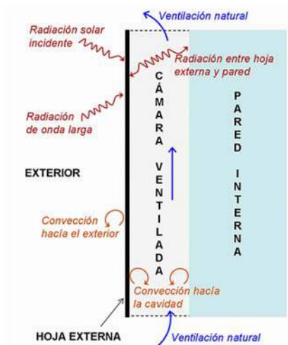
Esquema funcionamiento módulo "Exterior Naturally Vented Cavity"
