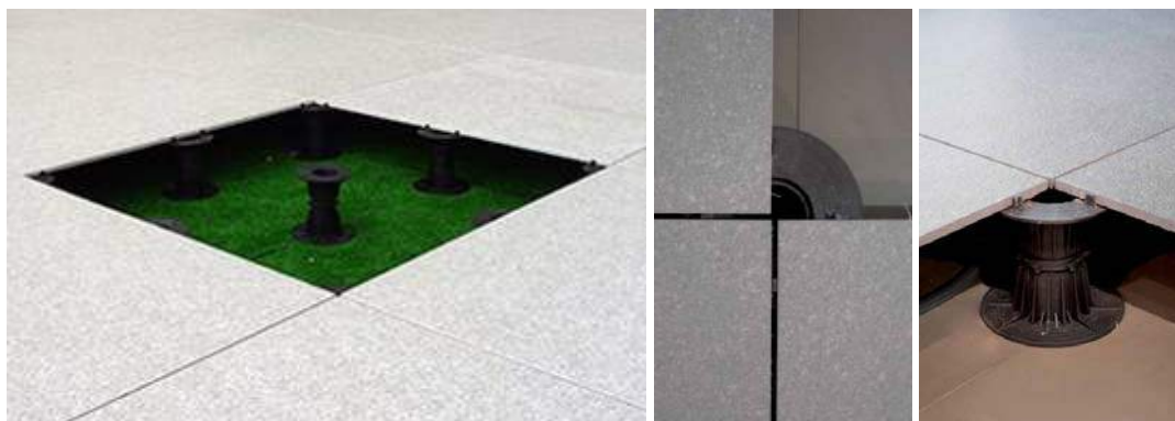
Detalle de un suelo flotante exterior con baldosa cerámica de 11mm. Wandegar
