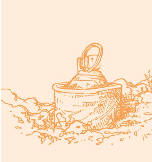
**Alivio de tensión.** Funciona al distensionar el cable, alambre o cuerda que hace las veces de mecanismo detonador.
