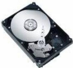
**Disco duro:** es un dispositivo de almacenamiento no volátil es decir, conserva la información aún con la pérdida de energía. Es un dispositivo que está fijo dentro del computador por lo que no permite transportar información de lado a otro.
