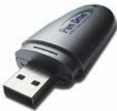
**Memoria USB (de Universal Serial Bus), conocida como Pendrive ó USB flash drive en inglés:** es un dispositivo de almacenamiento que utiliza memoria flash para guardar la información. Por su pequeño tamaño es muy utilizado para transportar datos de un lugar a otro. Es muy utilizado en la casa, escuela o lugar de trabajo.
