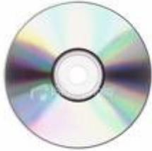
**Disco de Vídeo Digital (DVD):** es un soporte de almacenamiento óptico que puede ser usado para guardar datos, imagen o sonido. Permite guardar hasta 4,7 Gigabytes (GB).
