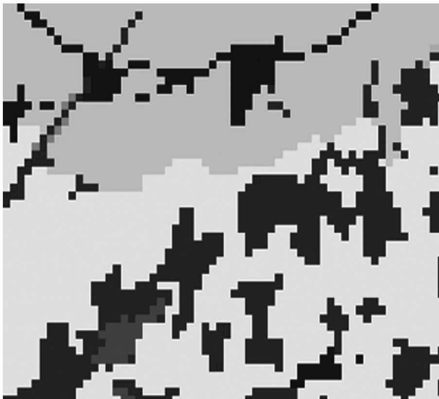
Muestra de una malla regular de celdas en un *SIG raster*. Cada celda contiene información asociada sobre un uso del suelo.
