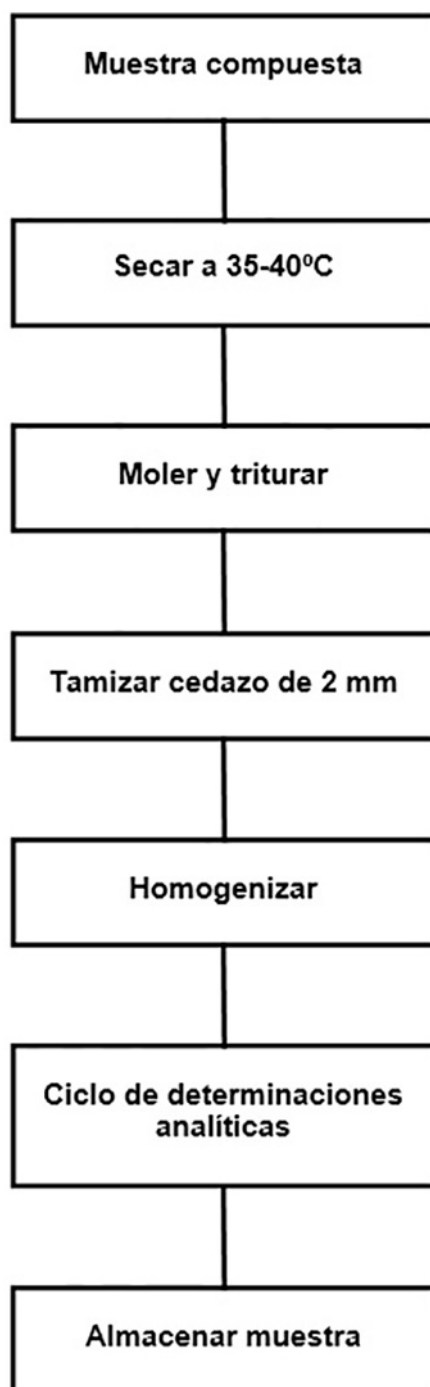
Diagrama de flujo del acondicionamiento de la muestra de suelo.
