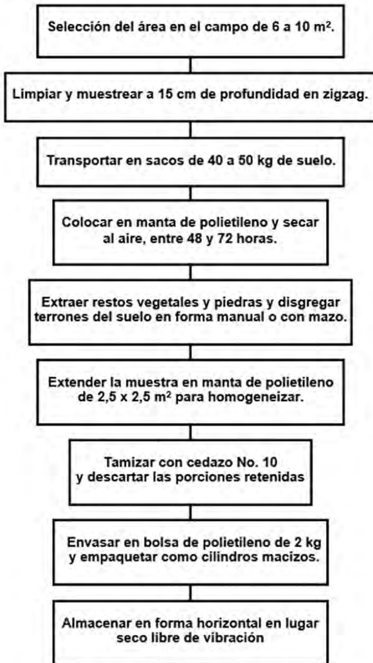
Diagrama de flujo del muestreo, preparación y conservación de la muestra de referencia interna (MRI).
