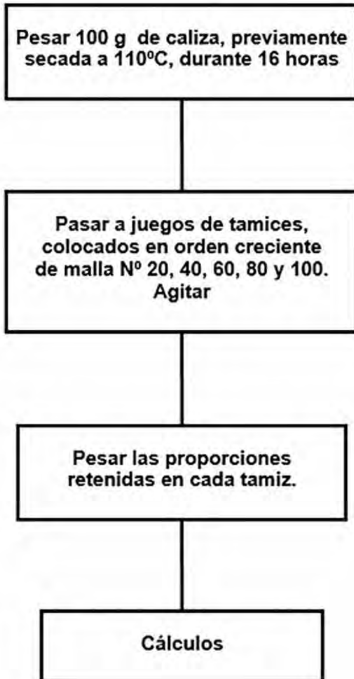
Diagrama de flujo de la determinación del tamaño de partículas de la caliza agrícola.
