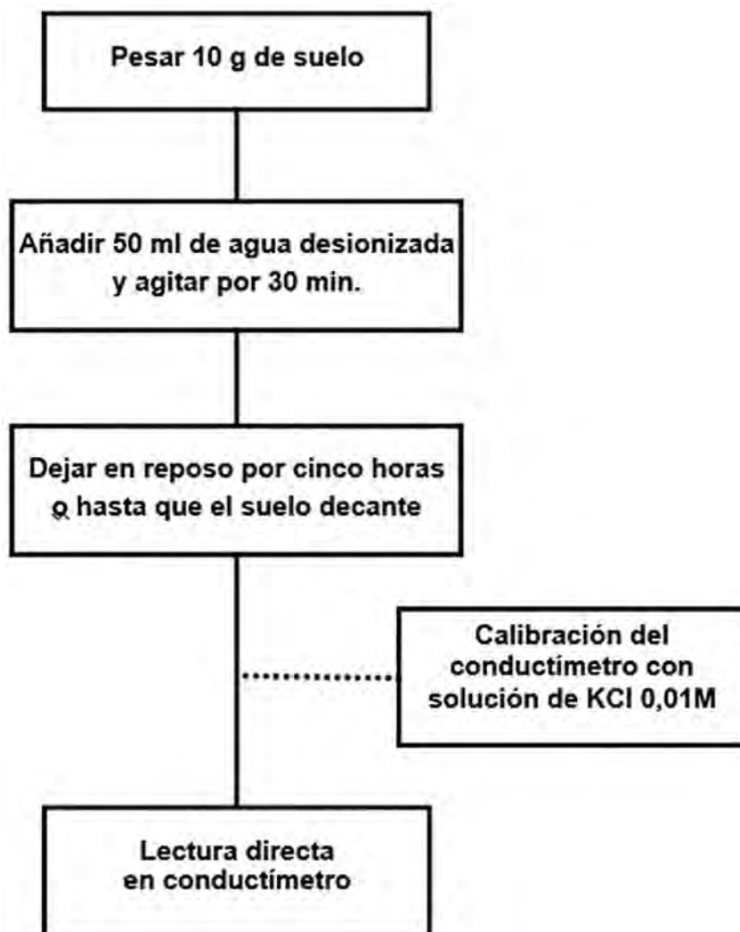
Diagrama de flujo de la determinación de conductividad eléctrica (CE). Relación suelo-agua 1:5.
